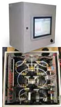
System poboru 30 prób powietrza z otoczenia wraz z montowanym na ścianie analizatorem FTIR.
