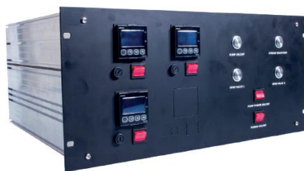
Rys. 3. Moduł SSC dedykowany do stojaka 19".
